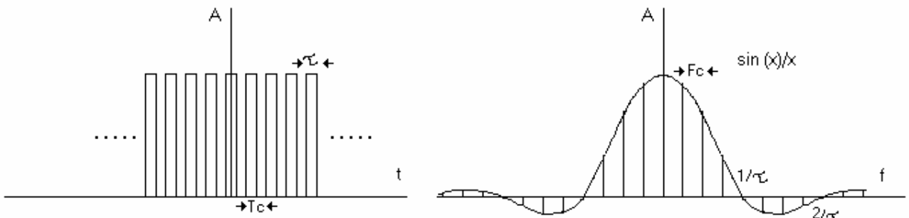
Figura 15.2 Se la durata di ciascun impulso è finita, allora lo spettro non è più piatto ma segue l'andamento della funzione \sin(x)/x .
